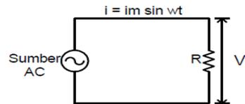
Gambar 2.2 : Rangkaian Resistor
