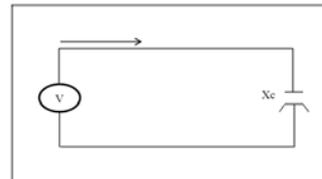
Gambar 2.14 : Rangkaian untuk menentukan daya reaktif kapasitif
